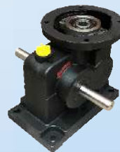
工程尼龍外殼斜齒輪減速機 EN PLASTIC BODY BEVEL GEAR REDUCER T85EN2L (d 25MM, 20CrMnTi, 1:14/1:16)
